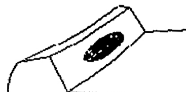
Рис. 7. Пятно контакта зубьев в конических шестернях
